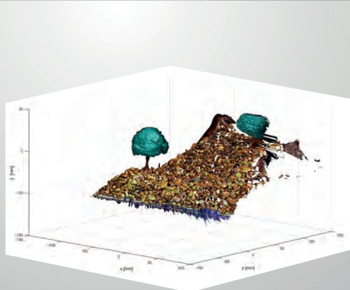
La precisión y facilidad de uso de los sistemas de visión permite realizar mediciones de campo en 3D para evaluar condiciones de suelo tales como asentamientos y erosión. Asimismo, los sistemas de digitalización 3D permiten monitorear la dinámica de los suelos para evaluar el impacto de la actividad humana tal como la construcción de autopistas, puentes, túneles y edificios.
