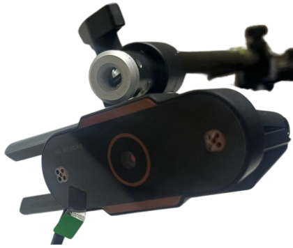
Figura 2: Arreglo experimental del sistema de proyección de franjas. (a) Webcam Logitech C310. (b) Proyector Epson W39.
